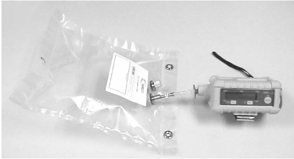
气体校正的连接图
